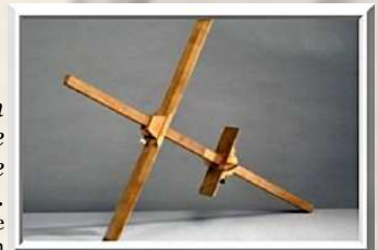
Reproduction d'un bâton de Jacob du Musée de la Marine. Cl Observatoire de Paris Meudon
