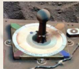
Gnomon installé sur les véhicules martiens Spirit et Opportunity. Cl NASA
