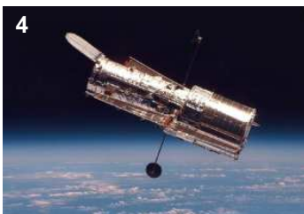
4 - Le télescope spatial Hubble (HST) dont le diamètre est de 2,40 m travaille en dehors de l'atmosphère terrestre. Il peut donc atteindre la résolution instrumentale maximale. Il permet aux astronomes de réaliser des observations sans la dégradation due à l'atmosphère terrestre (Cl NASA)
